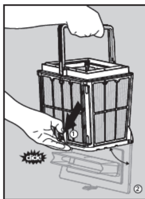
6.1.4 Откройте замок и откиньте нижнюю стенку корзины для удаления грязи.
